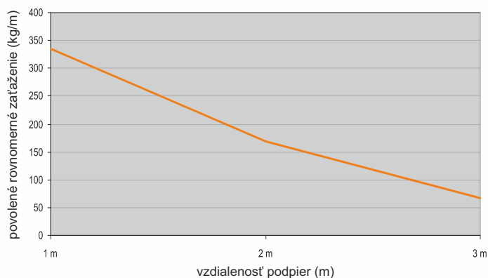
Graf znázorňuje maximálne povolené rovnomerné zaťaženie káblovej lávky v závislosti na vzdialenosti podpier
